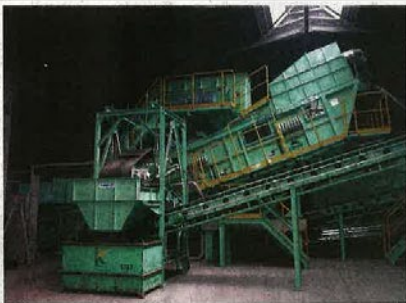
大型選別機のバリオセバレーター
